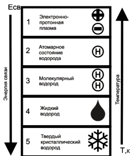
Рис. 1.3. Схема энергетических уровней водорода
