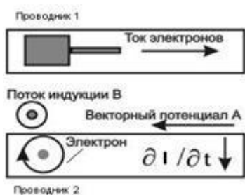
Рис. 6.2. Схема электромагнитной индукции
